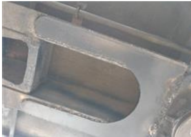
Рисунок 1.10 – Посилююча накладка консольної частини хребтової балки.
