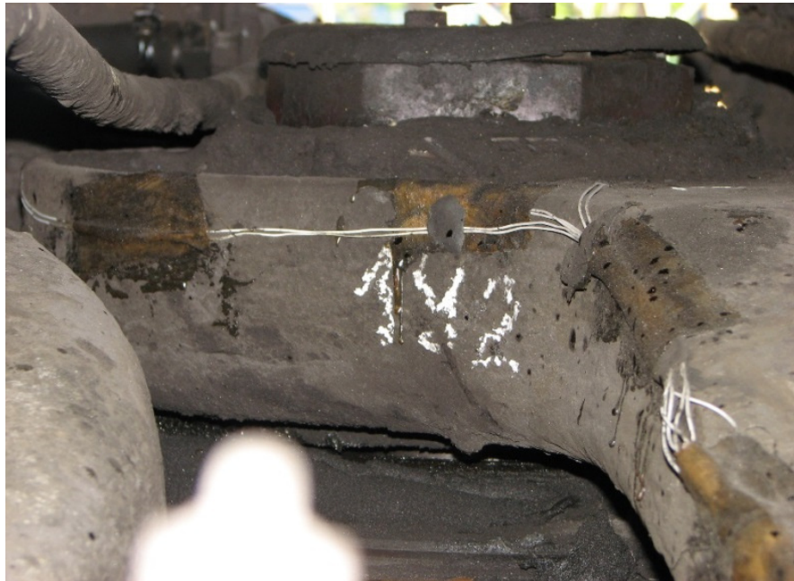
Рисунок 1.12 – Місце наклеювання датчика зусилля в зчленуванні візків 11У2, пропорційного тяговому зусиллю при ходових міцнісних випробуваннях магістрального електровоза постійного струму ВЛ-8 за даними НДР [48].
