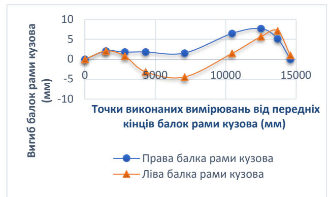
Рисунок 3.2 – Графіки даних: а) отриманих в процесі безпосереднього вимірювання; б) отриманих після математичної обробки.
