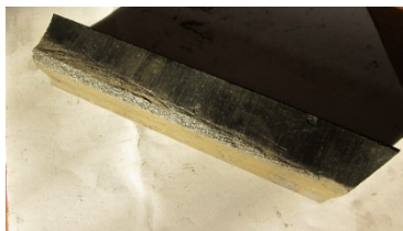
Рисунок 3.4 – Викришування секцій накладок типів після проведення скорочених експлуатаційних випробувань.
