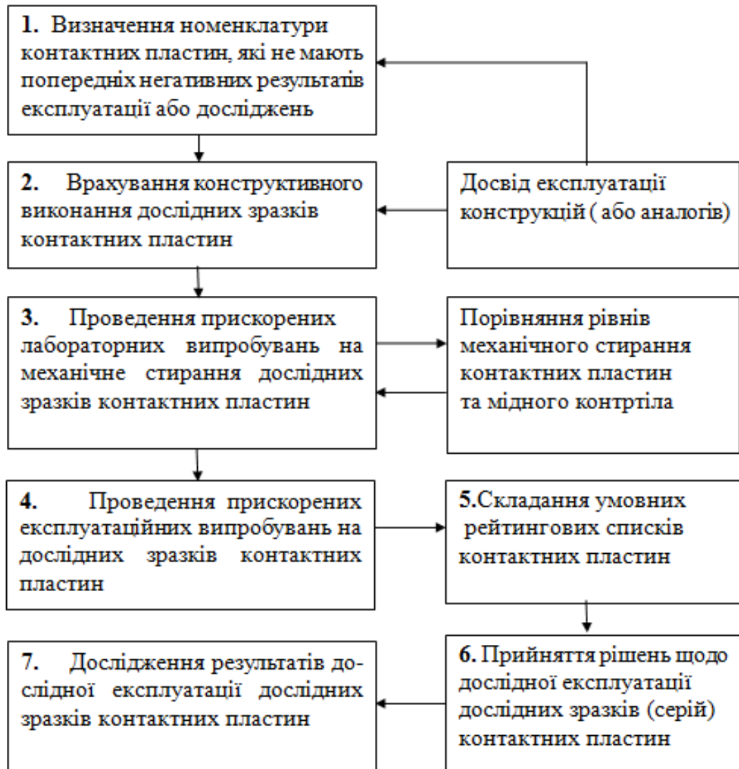
Рисунок 1.6 – Методика порівняльної оцінки якості контактних пластин
